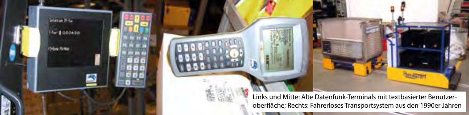
Links und Mitte: Alte Datenfunk-Terminals mit textbasierter Benutzeroberfläche; Rechts: Fahrerloses Transportsystem aus den 1990er Jahren
